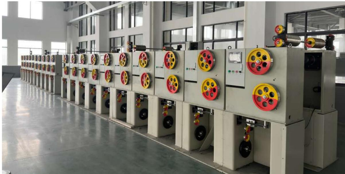
金属线缆收放设备按控制方式和机械结构的不同来区分，可分为并丝机、收线机、重绕机等多种设备。收线机是金属线材加工中负责收集成品线材的设备。具备可调节的收线速度和张力控制功能，确保线材紧密有序收卷，广泛应用于各类金属线材生产企业。
