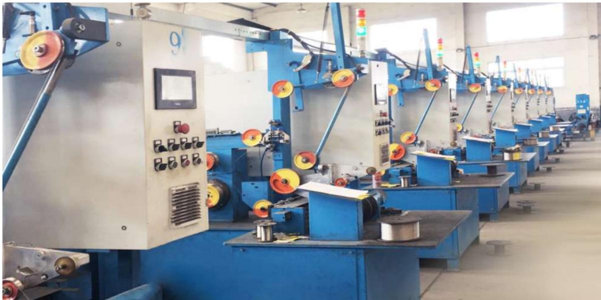
捻股是将绳股围绕绳芯中心线作螺旋线排列生产钢丝绳的工艺过程。捻股机是指将若干金属丝按一定的捻距、捻向捻制成绳股的设备。按机体结构类型分为筐篮式捻照机、管式捻股机和无管式捻股机(双捻机、跳绳式捻股机)。
