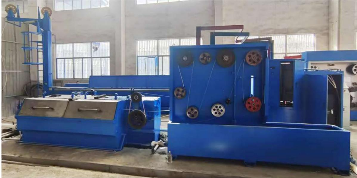
大拉机工艺是金属线材加工中的关键环节，主要用于将铜、铝等金属通过拉伸工艺加工成细丝，配备高精度的模具和先进的张力控制系统，可确保生产出的线材粗细均匀、质量稳定。铜铝大拉机广泛运用于电线电缆、建筑、交通运输等领域。
