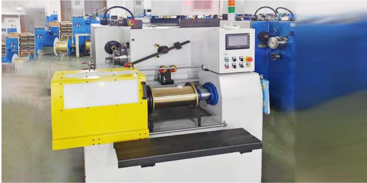
拉丝是将直径较粗的材料通过多级拉拔，将材料拉到所需要规格的工艺过程。按控制方式和机械结构的不同来区分，可以分为水箱式、滑轮式、直进式等多种拉丝设备。
