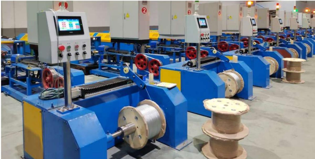
捻股是将绳股围绕绳芯中心线作螺旋线排列生产钢丝绳的工艺过程。捻股机是指将若干金属丝按一定的捻距、捻向捻制成绳股的设备。按机体结构类型分为筐篮式捻股机、管式捻股机和无管式捻股机(双捻机、跳绳式捻股机)。
