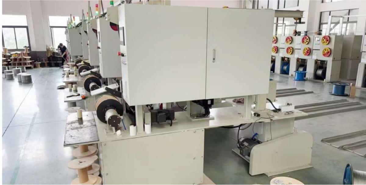
金属线缆收放设备按控制方式和机械结构的不同来区分，可分为并丝机、收线机、重绕机等多种设备。重绕机主要用于将已成型的线圈或线材重新卷绕，它能调整线材或线圈的绕制方式、线径分布等，常被应用于电机维修、变压器制造等领域。
