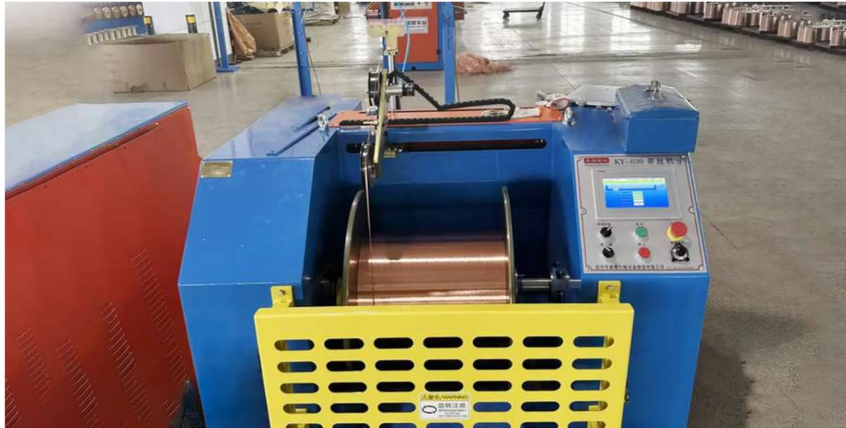
金属线缆收放设备按控制方式和机械结构的不同来区分,可分为并丝机、收线机、重绕机等多种设备。并丝机是用于将多根单丝合并成一股丝线的设备。常用于纺织、化纤、电线电缆等行业,能提升产品性能和生产效率。
