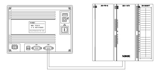
在本例中,触摸屏作为通讯主站,将扩展模块的输入点状态读至触摸屏本地线圈状态上,将触摸屏内部线圈状态写至扩展模块输出点上,其对应关系如下所示:
