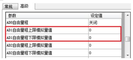
假设用户设定通道输入范围为 0~10V、自由量程上限模拟量值为 1000、下限模拟量值为 5000,则表示限制采样范围是 1~5V,如果输入电压超过 5V,其对应数字量显示仍为 32767。
