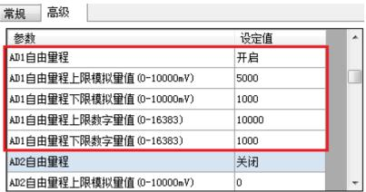
自由量程上限模拟量值设为 5000、下限模拟量值设为 1000,上限数字量值设为 10000,下线数字量值设为 1000。当输入电压超过 5V,其对应数字量显示仍为 10000。
