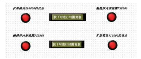
进行扩展模块 X10000 的状态编辑,放置指示灯,指示灯对象类型为 0X,对应 Modbus 地址线圈为 20736;选择功能键按钮,按键功能为按下时将 X10000 的线圈状态复制到触摸屏内部 PSB500 号线圈;编辑触摸屏内部线圈 PSB500 指示灯,选择指示灯对象类型为 PSB,指定线圈号为 500。
