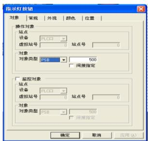
同样,编辑触摸屏内部线圈 PSB501 号线圈状态,放置指示灯按钮,指示灯按钮对象类型为 PSB,指定线圈号为 501;选择功能键按钮,按键功能为按下时将 PSB501 的线圈状态复制到扩展模
