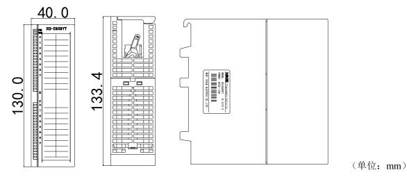
XG 系列 64 点输入输出模块的外形及尺寸请参照下图:
