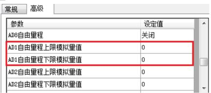
假设用户设定通道输入范围为 0~20mA、自由量程上限模拟量值为 1000、下限模拟量值为 5000,则 表示限制采样范围是 1~5mA,如果输入电流超过 5mA,其对应数字量显示仍为 16383。
