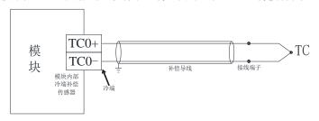
● 模块提供"内部补偿"和"固定值补偿"两种冷端补偿方式,"冷端补偿方式选择"用于切换冷端补偿方式,出厂默认为"内部补偿",此时冷端温度采用模块内置的冷端传感器采集的温度;当设定为"固定值补偿"时,冷端温度采用设定的"固定值补偿温度","固定值补偿温度"默认为250(25.0℃),设定范围为-1000~1000,但需注意设定的"固定值补偿温度"一定需要和实际冷端所在位置的温度一致。
