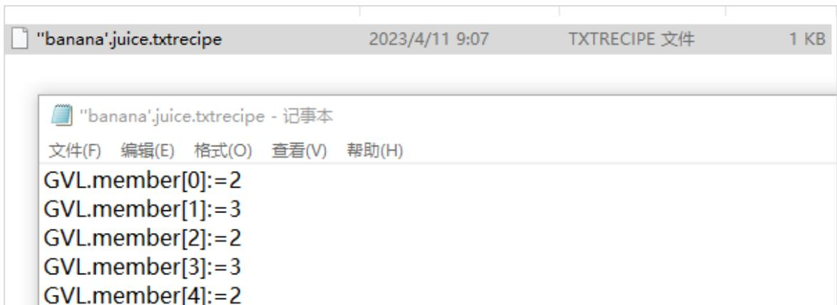
2、可以直接在记事本中将配方更改为‘2、3、2、5、4’，然后导入到 PLC 中，并使用 RecipeManCommands.LoadAndWriteRecipe 指令可以将配方中数据直接读到 PLC 中；
